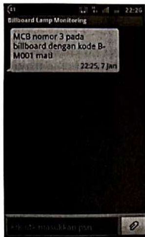
Gambar 12 Tampilan Layar SMS Laporan Pada User Saat Salah Satu MCB Lampu Billboard B-M001 Dalam Kondisi Mati
