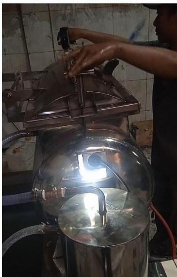
10. Pastikan semua kran dalam keadaan tertutup dan hidupkan pompa air dengan handle saklar pompa. Buka kran penghubung tabung dan kondensor supaya pompa dapat memulai proses pemvakuman
