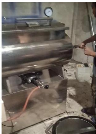
14.Cara mengetahui produk sudah matang atau belum dengan mengamati kondisi dalam tabung penggorengan. Tekanlah saklar lampu pada panel control untuk melihat kondisi didalam tabung. Jika kondisi permukaan minyak sudah tenang (tidak ada pergelangan gelembung udara/gelembung udara lembut dan hamper habis) maka bahan sudah matang
