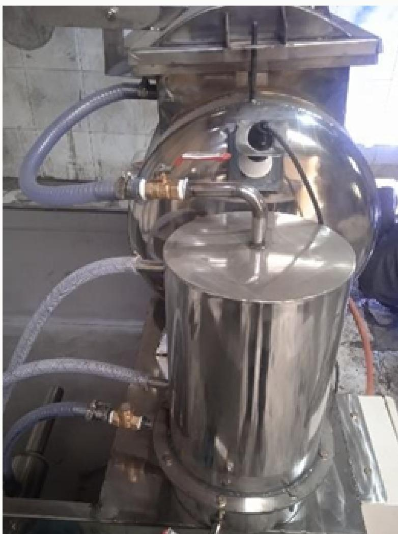
10. Pastikan semua kran dalam keadaan tertutup dan hidupkan pompa air dengan handle saklar pompa. Buka kran penghubung tabung dan kondensor supaya pompa dapat memulai proses pemvakuman
