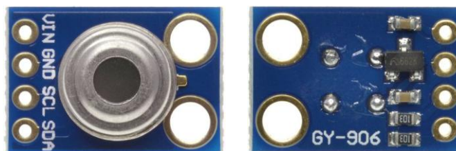
Gambar 2. 4. Sensor suhu MLX-90614 dengan modul GY-904
