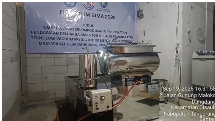
Gambar 6. 3 Mesin vacuum frying untuk produksi keripik buah
