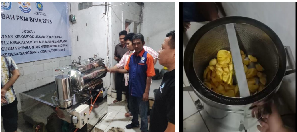
Gambar 5. 2 Uji coba mesin vacuum frying (a) Proses penggorengan buah (b) Proses penirisan minyak (spinning)
