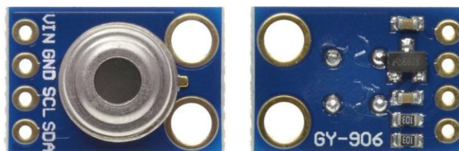
Gambar 2. 4. Sensor suhu MLX-90614 dengan modul GY-904
