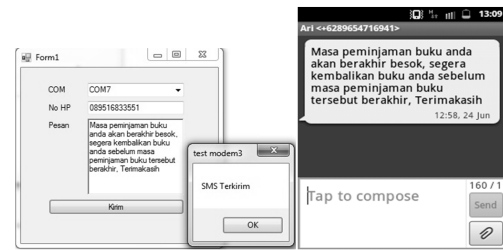
Gambar 14. Hasil uji koneksi Modem GSM dengan pengiriman pesan
