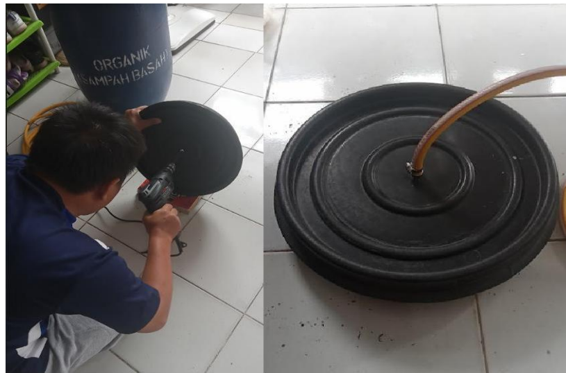
Gambar 6 Proses Pembuatan Tabung Biodigester
