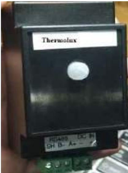
Gambar 4. Integrasi sensor suhu, kelembaban dan cahaya dengan protokol modbus
