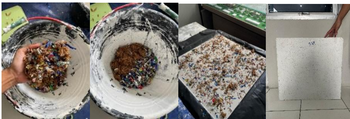
Gambar 6. Pembuatan Papan Panel Daur Ulang Sampah Mix ketebalan 1 cm
