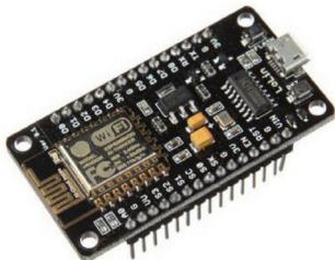
Gambar 2: NodeMCU Esp8266 v3
