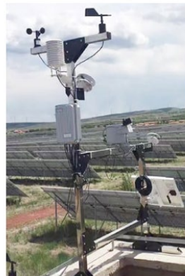
Gambar 3. Metode Tradisional untuk Deteksi Anomali Panas Menggunakan Sensor Suhu, Kelembapan, Barometrik, dan Tekanan
