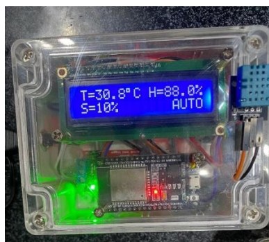
Gambar 6. Tampilan Alat Dalam Mode Otomatis dan Kondisi Tidak Menyiram
