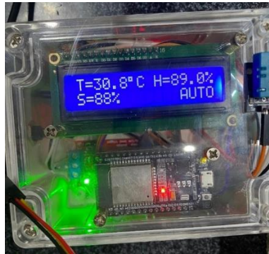
Gambar 7. Tampilan Alat Dalam Mode Otomatis dan Kondisi Menyiram
