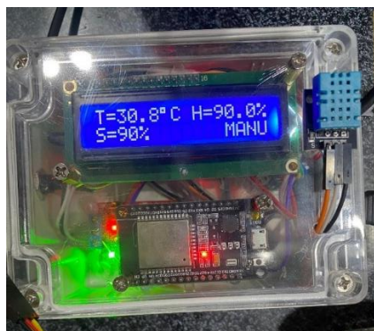
Gambar 9. Tampilan Alat Dalam Mode Manual dan kondisi menyiram
