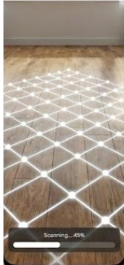
Gambar. 3 Tampilan Antarmuka Deteksi Permukaan Menggunakan Teknologi Markerless AR.
