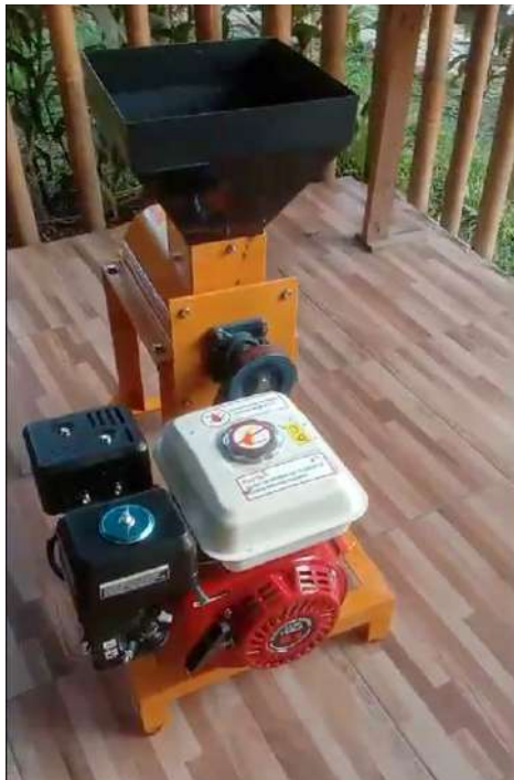
Gambar 12 Mesin Pembubur Sampah Organik
