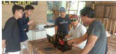
Gambar 9 Cetak Desain pada Tumbler Memanfaatkan Laser Engraver Mengacu pada rekapitulasi dan pencatatan yang dilakukan di setiap minggunya, didapatkan data produksi untuk tumbler seperti yang terlihat pada Tabel 6.
