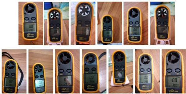
Gambar 4. Hasil pengukuran dengan anemometer dengan jendela terbuka.
