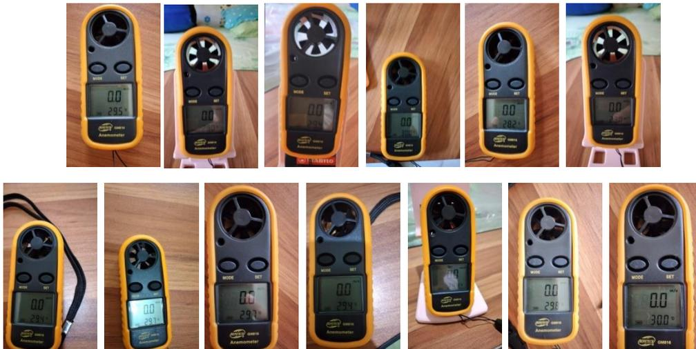
Gambar 4. Hasil pengukuran dengan anemometer dengan jendela terbuka.
