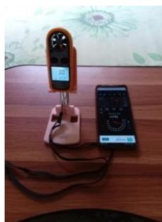
Gambar 1. Sound Level Meter dan Anemometer
