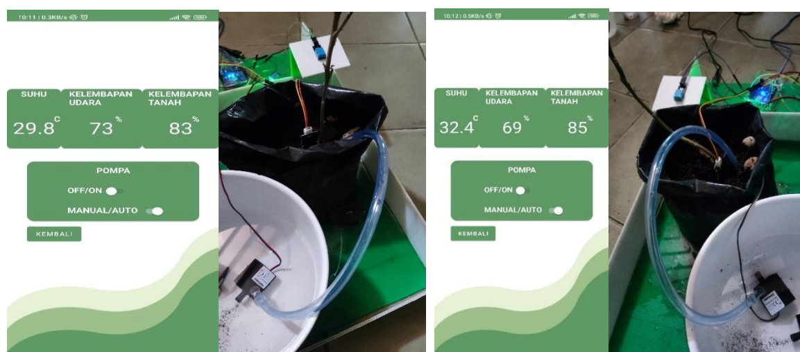
Gambar 12. Pengujian Switch pompa Mode Otomatis pada Alat 1 dan 2
