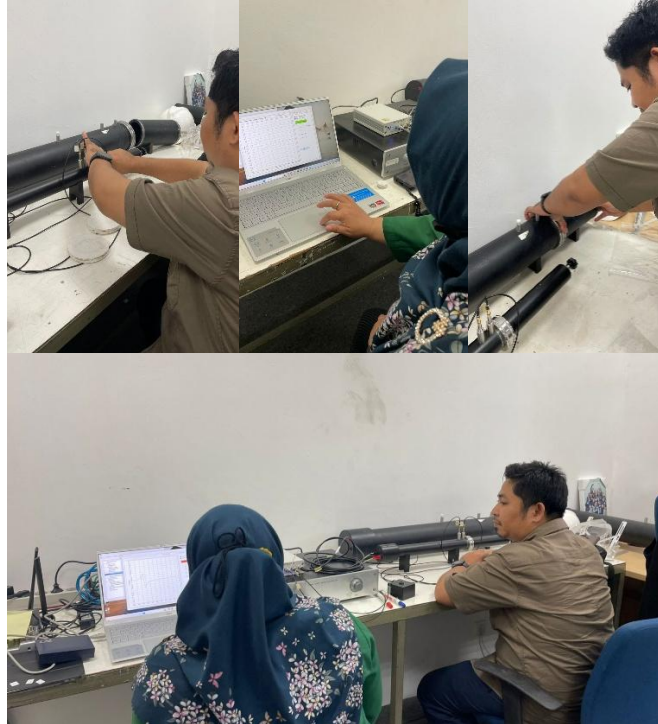
Gambar 6 Pengujian sampel papan panel menggunakan tabung impedansi
