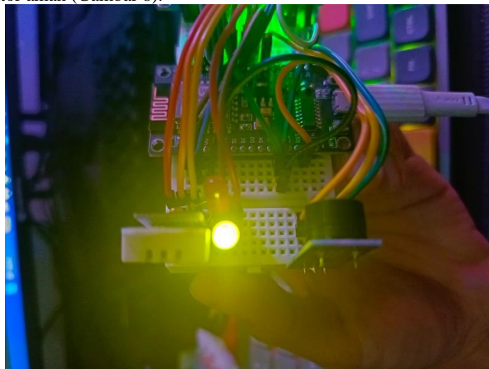
Gambar 8. Indikator Kondisi Normal (LED Hijau)
