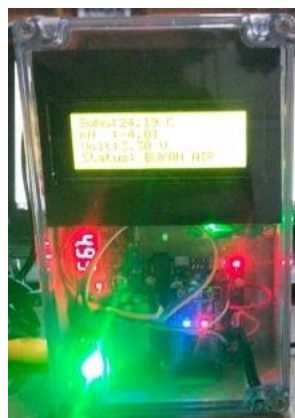
Gambar 6. Alat Monitoring Suhu dan pH Kolam Ikan
