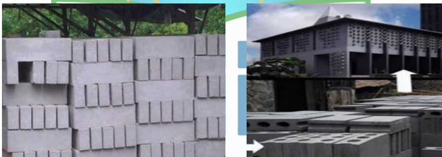
Gambar 82. Produksi Material Bata Abu Vulkanik
