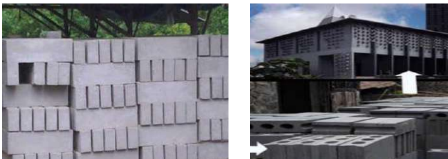
Gambar 82. Produksi Material Bata Abu Vulkanik
