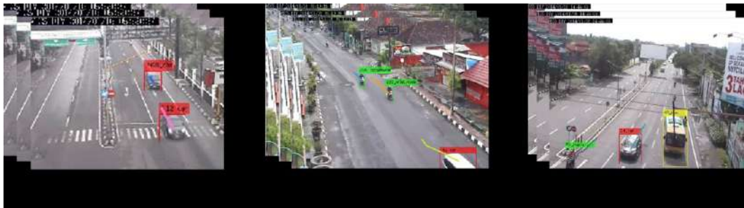
Gambar 5.20 Hasil pengujian pelacakan kendaraan berdasarkan Arsitektur SVS di Yogyakarta (a) Babar Sari, (b) Galeria, (c) Condong Catur
